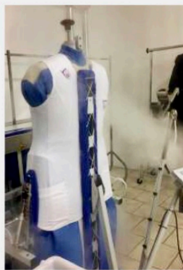
Die Dampf-Puppe, die Kittel und Hemden in Sekunden glatt bekommt, kostet 18.000 Euro. FOTOS (5): REGINE LOTZMANN
